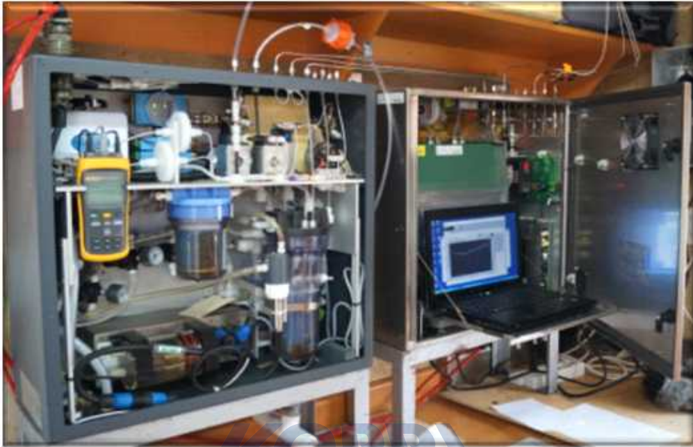
[그림 4-13] 해수평형기를 통한 비분산형적외선 분광분석 장비를 이용한 해양 및 대기 중 이산화탄소 관측 시스템
