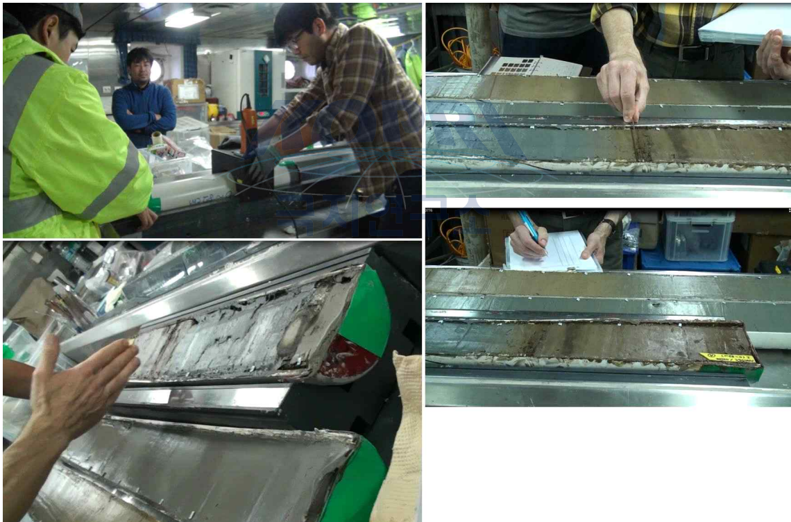
그림 3-28. 2015 '아라온' 서북극해 탐사에서 획득한 시추코어 퇴적물의 일부는 지질실험실에서 연구목적에 따라 절개 한 후 자세히 퇴적물의 특징을 기재하였다.
