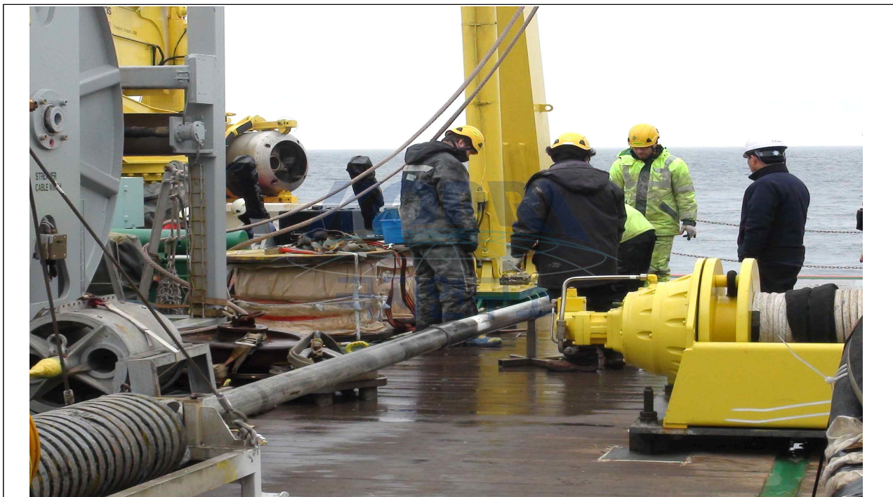
그림 3-26. 중력 코어를 이용하여 척치해 대륙붕에서 약 5.5 m 길이의 퇴적물 코어를 3점 시추하였다.
