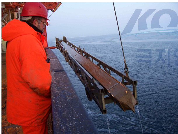
그림 2-14a. AWI ‘폴라스턴’에서 사용하고 있는 대형박스형 시추기(KAL)를 이용하여 2008년 서북극탐사에서 빙·해양퇴적물 코어를 시추하고 있다.
