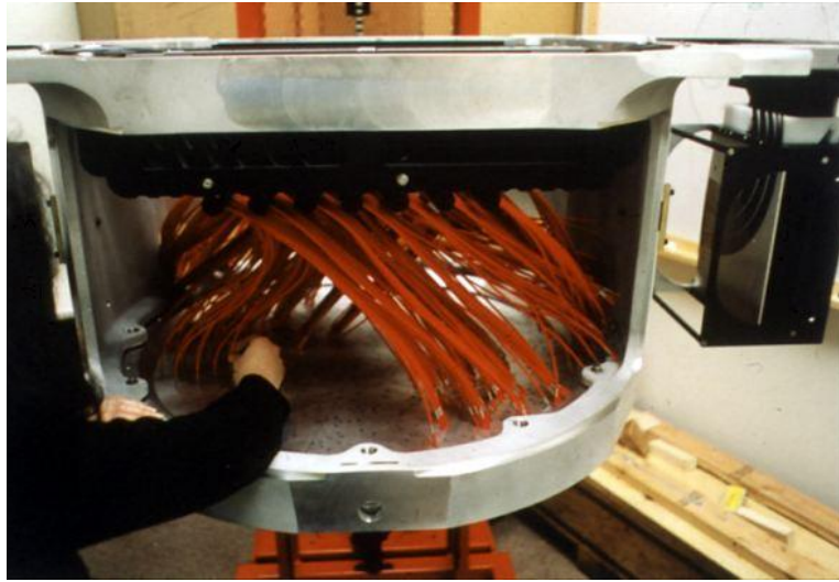
그림 1.2 SDSS 분광기의 플러그 플레이트 (Plugplate). (사진출처: http://classic.sdss.org/gallery/gal_photos.html )
