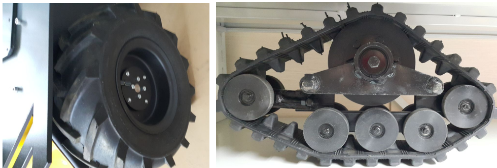
그림 2-5. 기본 14인치 타이어 및 설상 주행용 트랙
