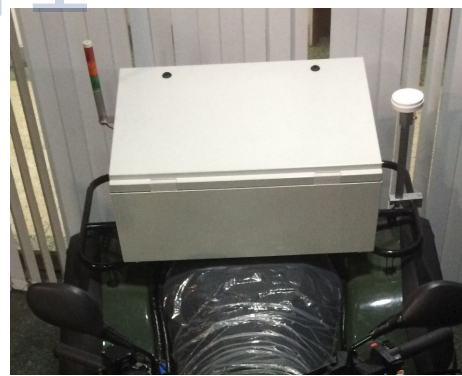
그림 3-4. 플랫폼에 설치된 제어기 박스
